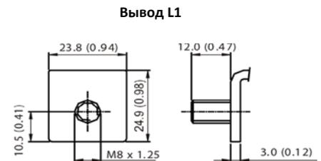
Усилие затяжки: L1 (10Nm±5%)
