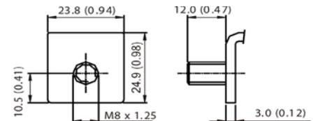
Усилие затяжки: L1 (10Nm±5%)
