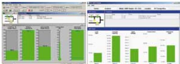
С помощью графического дисплея можно получить информацию: о состоянии батарей ИБП, температуре внутри ИБП, входного и выходного напряжения, получить подробные графики напряжений и частот с временной шкалой, просмотреть log файл событий и многое другое.
