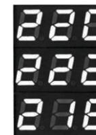
При включении прибор сразу начинает отображать значение напряжения на трех фазах.
