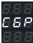
Кратковременное нажатие на среднюю кнопку отобразит на индикаторе фазы В «СБР» и загорится красным индикатор. При отпускании кнопки прибор сотрет из памяти все сохраненные значения напряжений на каждой фазе. Через 3 с после последнего нажатия кнопок, прибор вернется к индикации напряжения сети, индикатор красного цвета погаснет.
