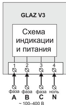
Схема 1. Упрощенная внутренняя схема и схема подключения.
