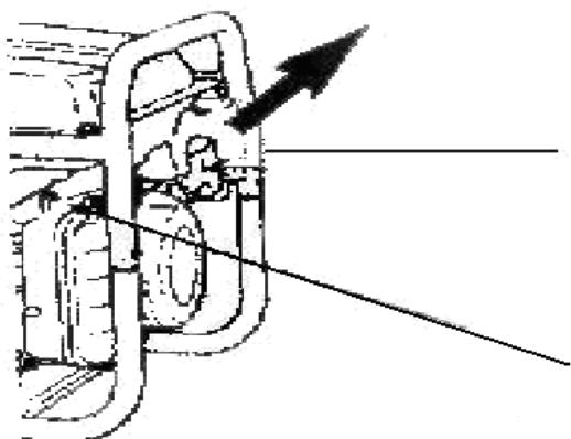
5. Повільно потягніть за шнур стартера до появі опору, утримуючи шнур стартера в натягнутому положенні, різко потягніть його.
