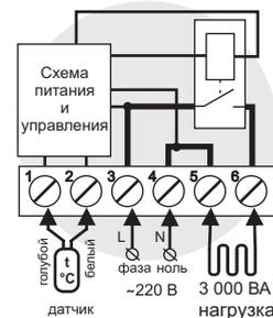
Схема 1. Упрощенная внутренняя схема и схема подключения
